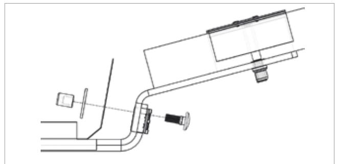
Unter die Ballastwanne wird links und rechts die selbstklebende Bautenschutzmatte die im Lieferumfang enthalten ist montiert.
