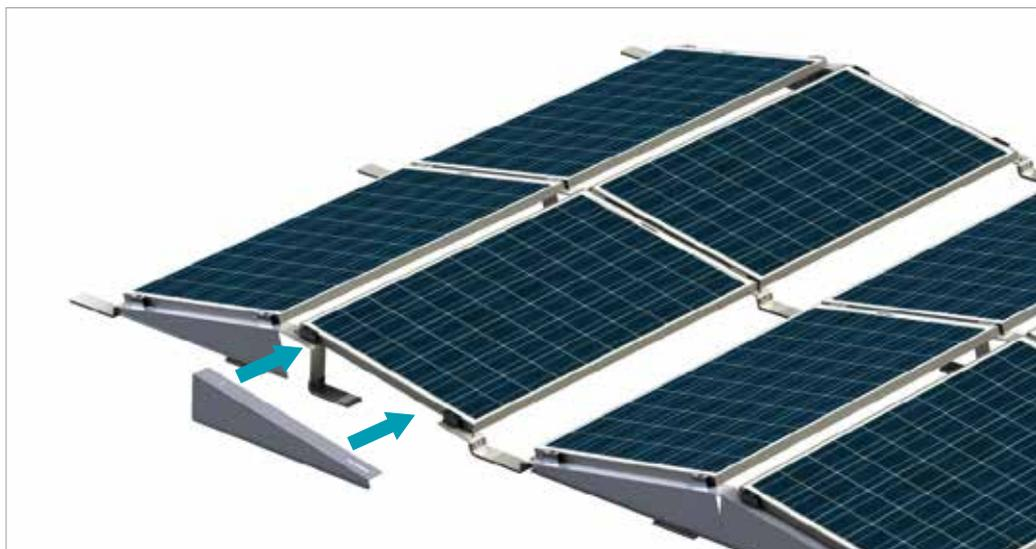
Seitenteil wird beim Montieren der Endklemme zwischen Klemme und Bügel mit eingeklemmt.
