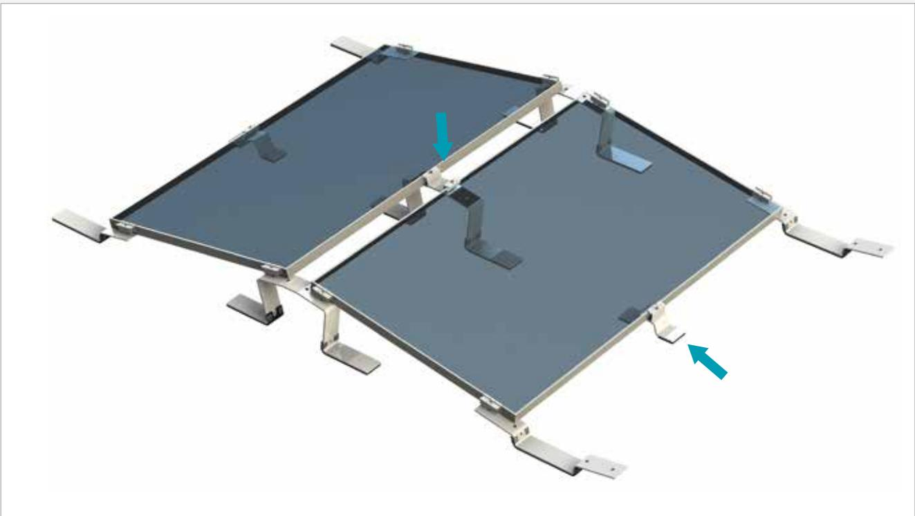
2. Vorderer Stützfuß mittels Endklemme in der Mitte des Moduls platzieren und festschrauben.
